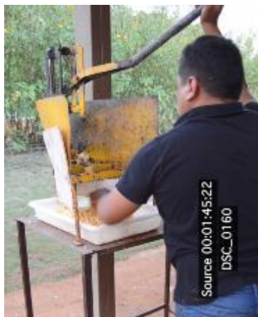
Figura (Figure) 2. Equipamento utilizado para a desgrana das espigas de milho-doce (Equipment used for the spreading of sweet corn ears
